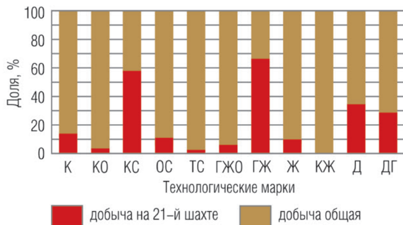
Рис. 6. Доля технологических марок угля, добываемых на особо опасных шахтах (21), в общей добыче в 2020 г. (по данным Минэнерго России, АО «Росинформуголь»)
