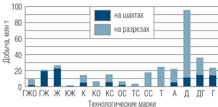
Рис. 2. Марочная структура добычи угля открытым и подземным способами в 2020 г. (по данным Минэнерго России, АО «Росинформуголь»)
