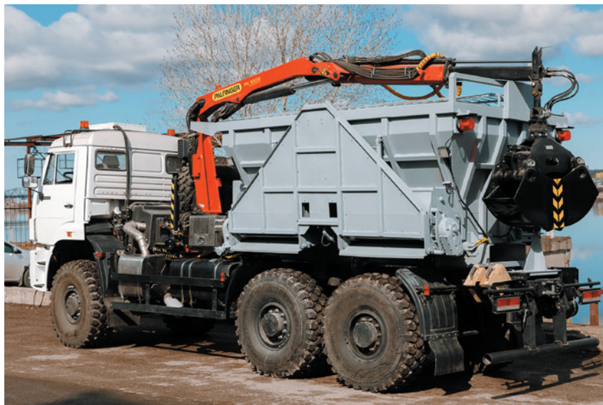
Забоечная машина ЗМ-7-Г, грузоподъемность 7 тонн с грейфером
